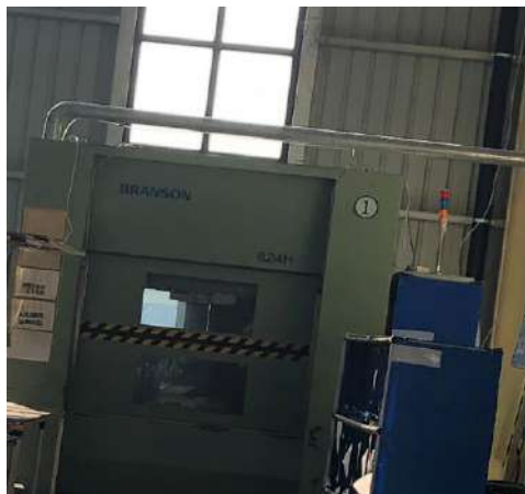
1#车间现有震动熔接废气收集
